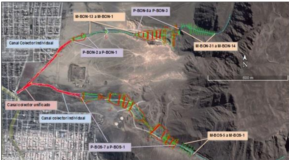
Figura 3.1 Disposición obras de control aluvional proyectadas
