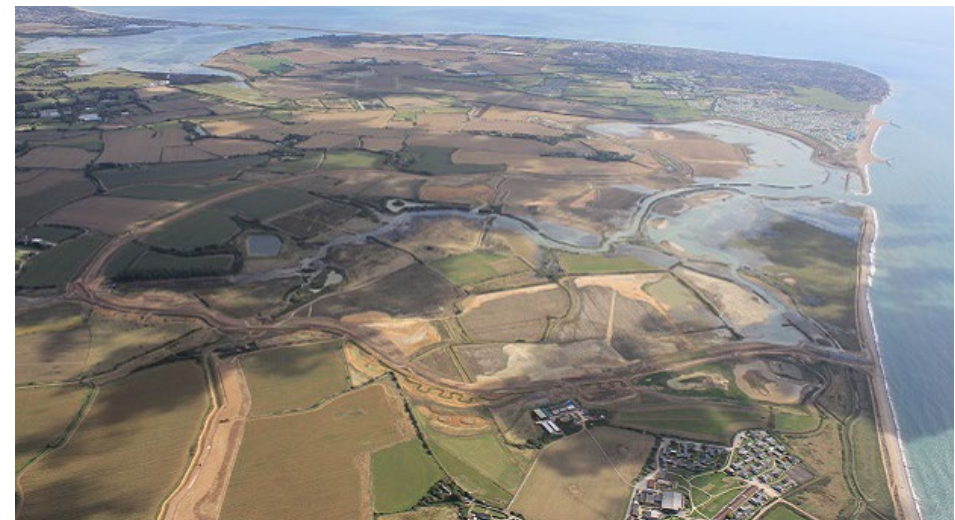
Figura 9. Una vista aérea del proyecto Medmerry. Interesados directos locales visitaron junto con la Agencia de Medio Ambiente una zanja de 110 m practicada en la orilla en el marco del proyecto Medmerry, que permite que el agua procedente de las mareas fluya para crear un nuevo hábitat intermareal con una superficie de 183 ha. © Environmental Agency. Contiene información del sector público con licencia de Open Government License v3.0.
