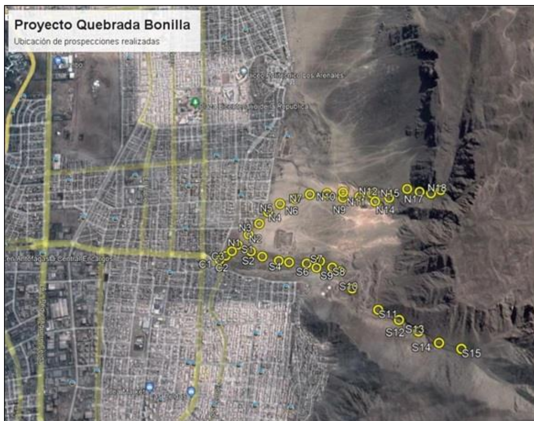
Fig. 8.1 Plano de ubicación de las calicatas excavadas
