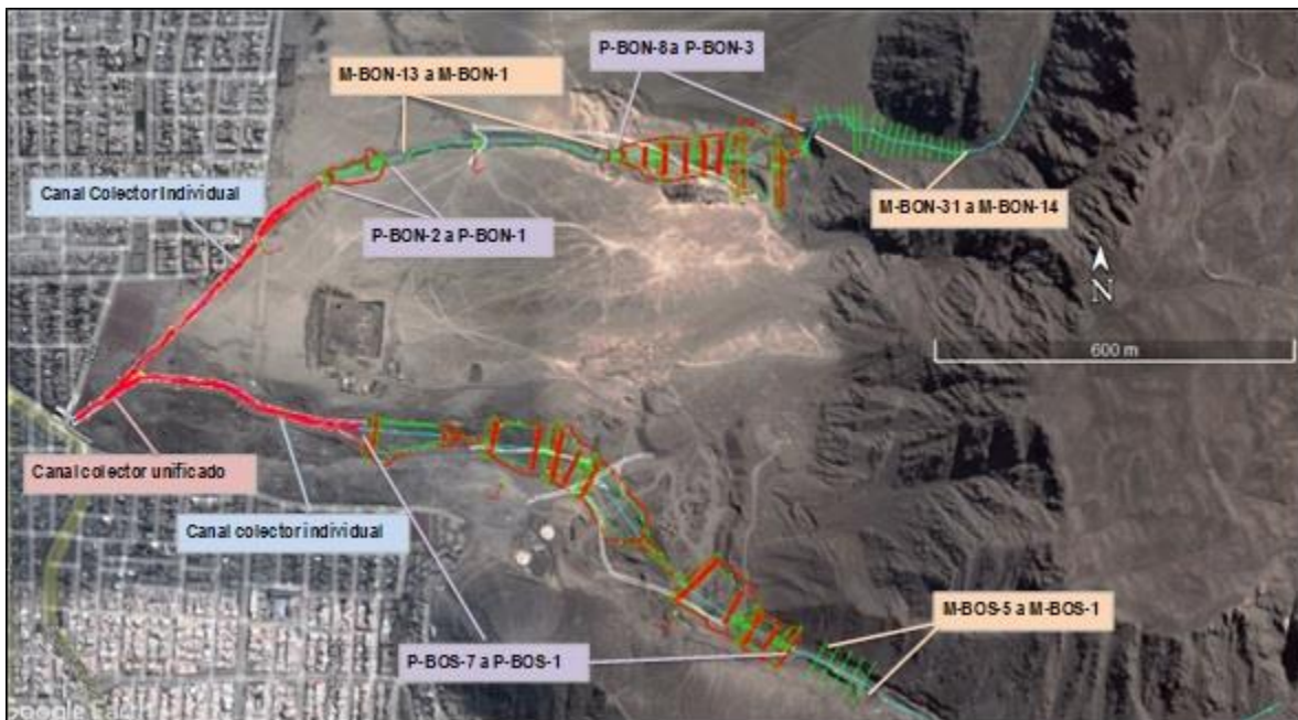
Figura 3.1 Disposición obras de control aluvional proyectadas
