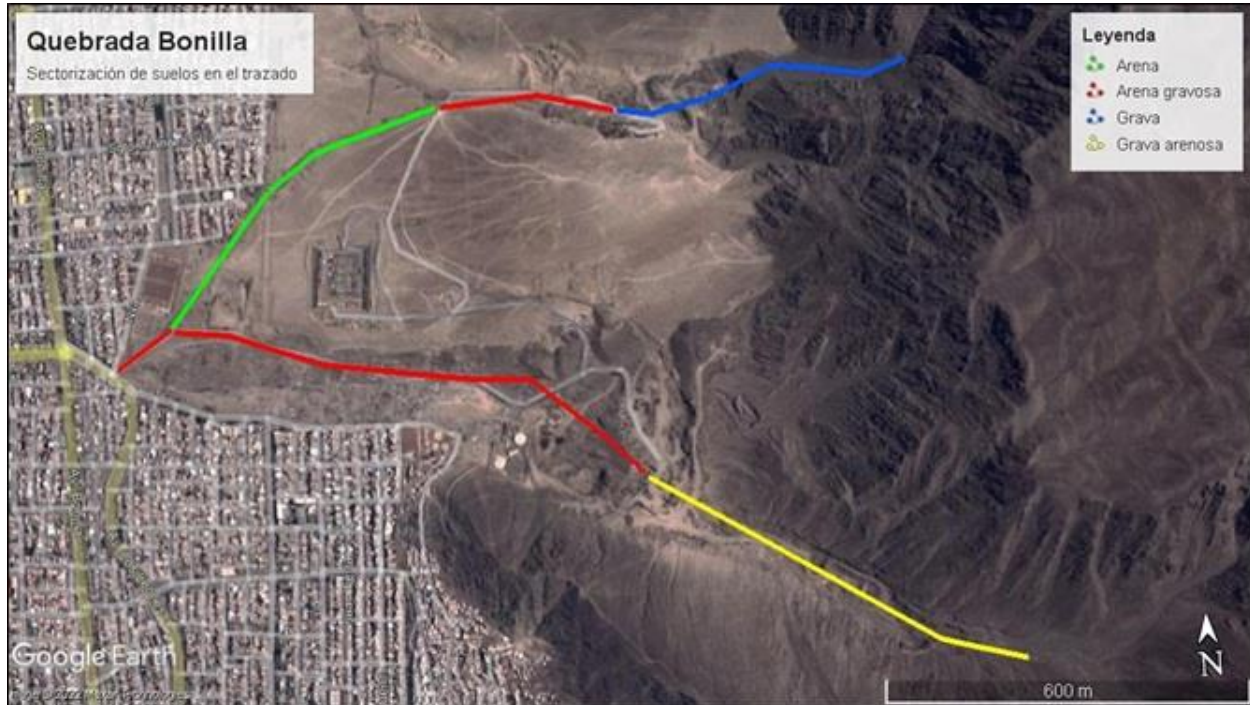
Figura 8.3 Sectorización del trazado según tipo de suelo
