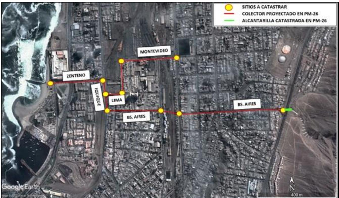
Finalmente la Figura 12.5 muestra el caso de la quebrada Riquelme, donde se observa que el canal colector ubicado aguas abajo de la obra disipadora de energía del sistema de muros estabilizadores de pendiente, baja con alta pendiente hasta descargar oblicuamente sobre la calle Teniente Ernesto Riquelme. Por su parte en la Figura 12.6, se observa el trazado del colector con indicación de los puntos que se propone catastrar.
