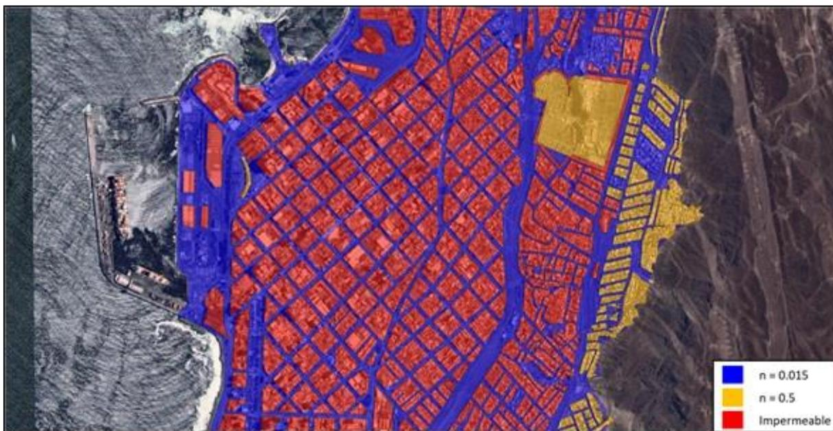
**Figura 9.7 Malla de escurrimiento y condiciones de borde en Quebrada Schneider**
