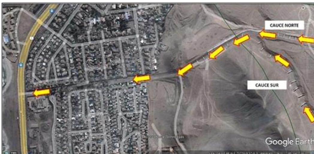
**Figura 5.32 Obra de control aluvional del cauce de la cuenca sur de la quebrada Jardín del Sur**
