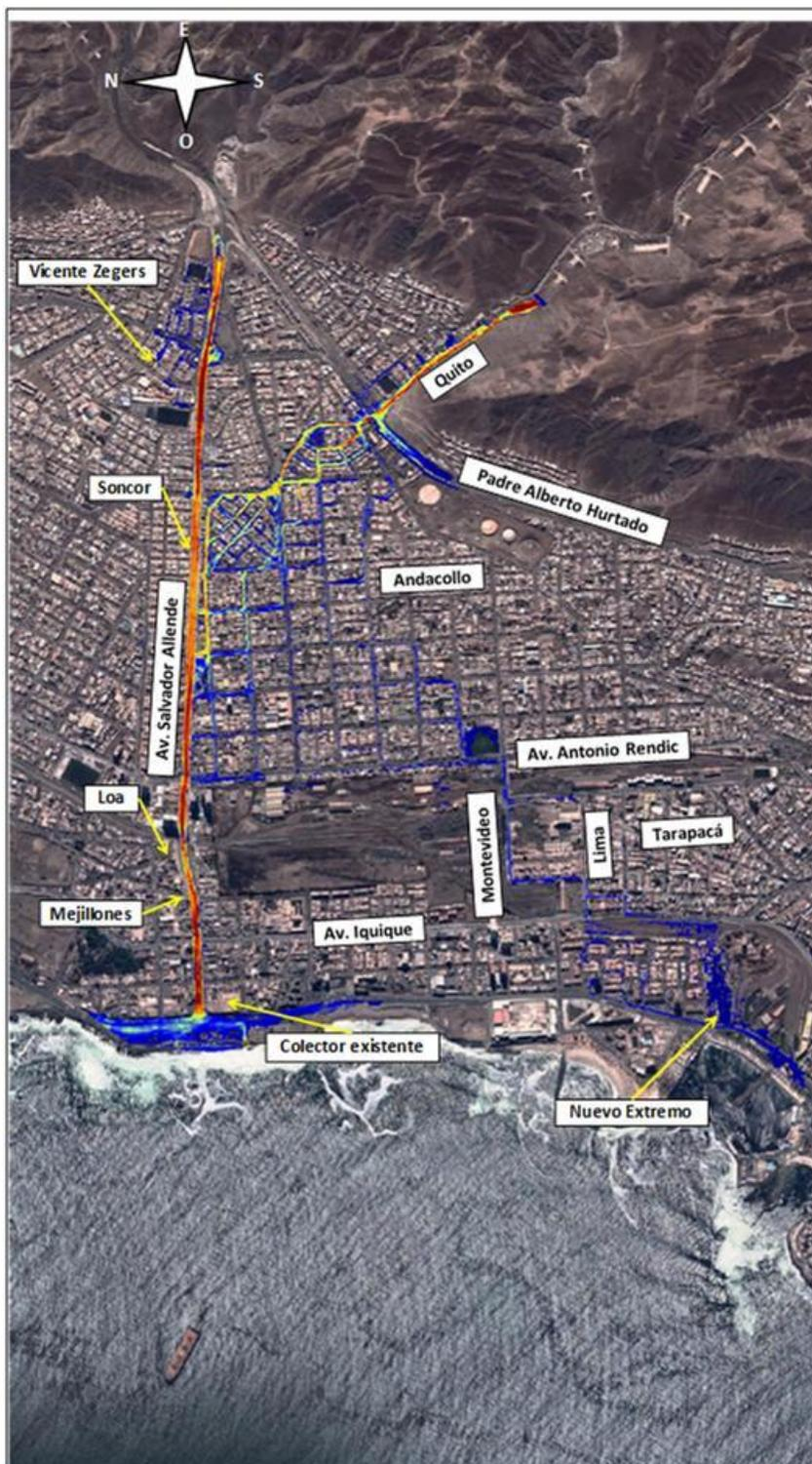
Figura 10.7 Áreas de inundación en quebradas Riquelme, Baquedano y Uribe para T=25 y T=100 años
